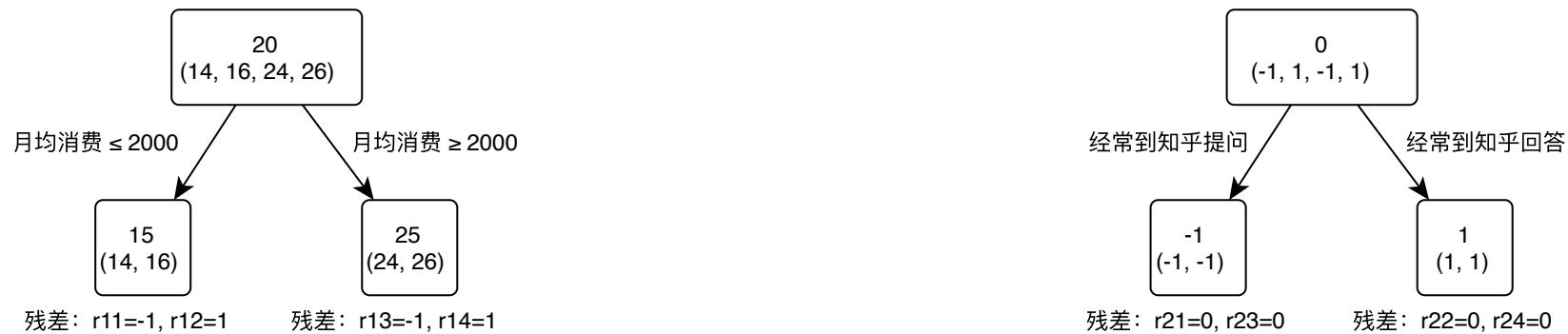
在训练第一棵树过程中，利用年龄作为预测值，根据计算可得由于  $p_1, p_2$  年龄相近， $p_3, p_4$  年龄相近被划分为两组。通过计算两组中真实年龄和预测的年龄的差值，可以得到第一棵树的残差  $R = \{-1, 1, -1, 1\}$ 。因此在训练第二棵树的过程中，利用第一棵树的残差作为预测值，最终所有人的年龄均正确被预测，即最终所有的残差均为 0。
